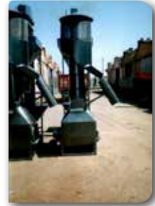
Şekil 3. Hava akımı ile boş-dolu ayırma
