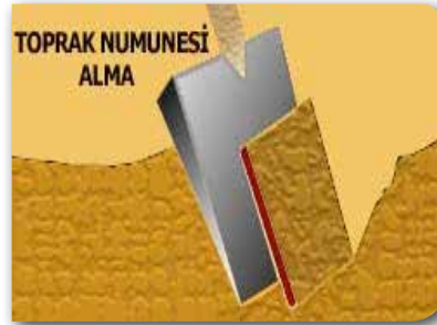
Şekil 1. Toprakta 'V' harfinde çukur kazılması ve toprak diliminin alınması
